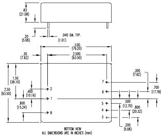
Pins 0.040 (1.0) dia x 0.20 (5.1) lg min.
